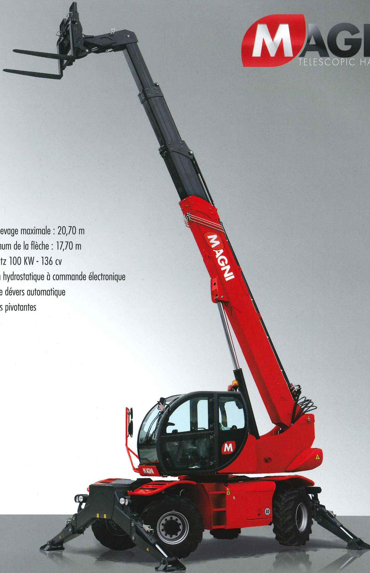
Hauteur de levage maximale : 20,70 m
