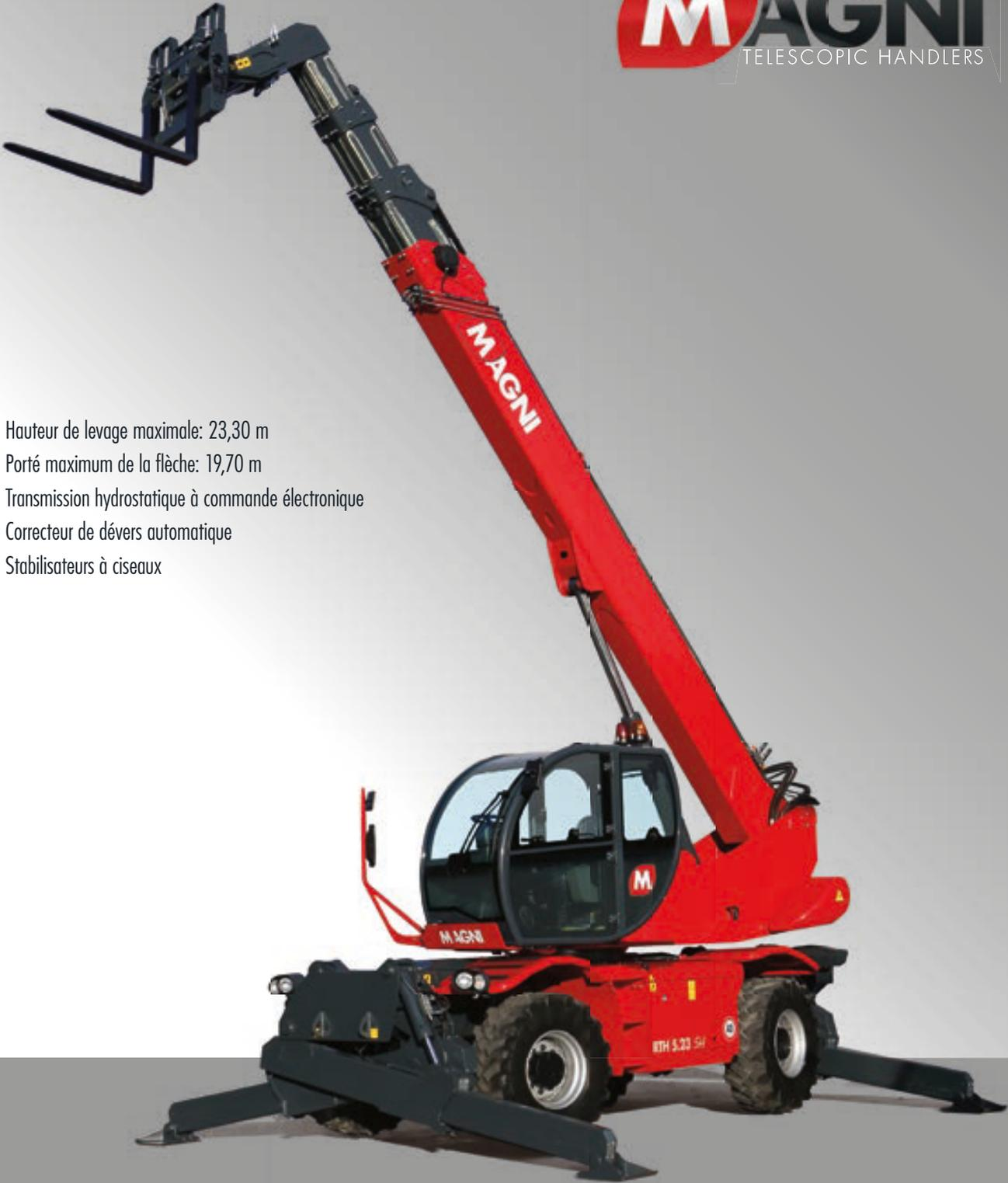
Hauteur de levage maximale: 23,30 m
